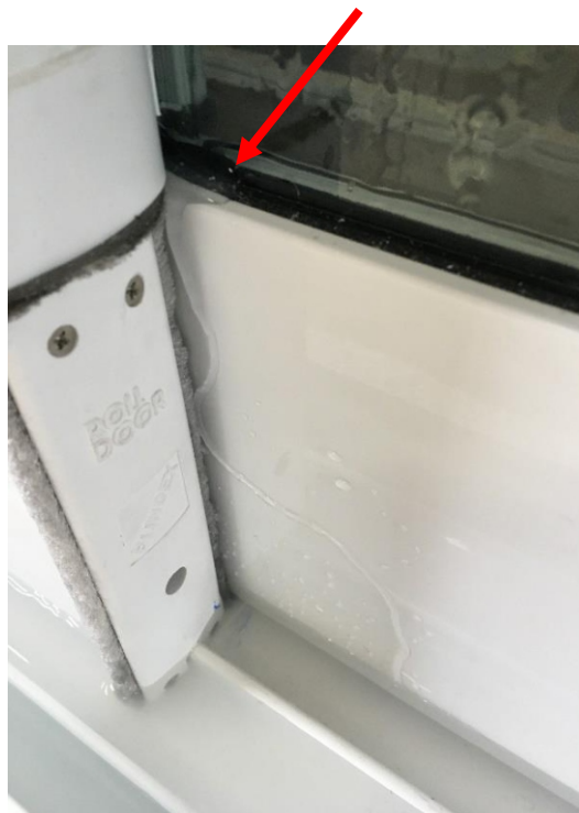
Foto n.º 02 – Visualização da ocorrência com 80 Pa – PI 02 min
