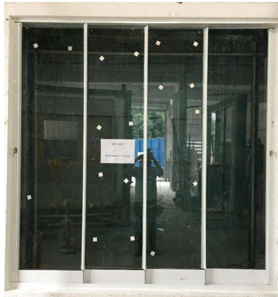
Foto n.º 01 – Visualização do ensaio de cargas uniformemente distribuídas.
