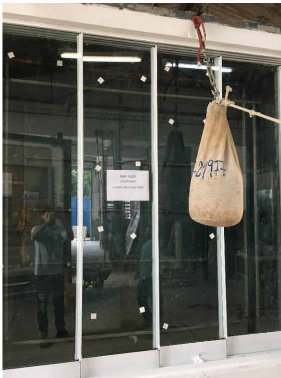
Foto n.º 04 – Visualização do ensaio de impacto de corpo mole.
