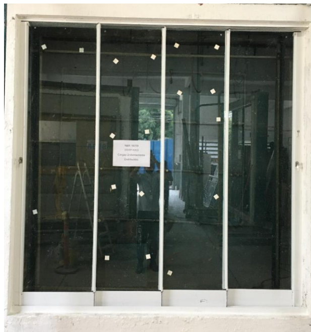
Foto n.º 03 – Visualização do ensaio de cargas uniformemente distribuídas.
